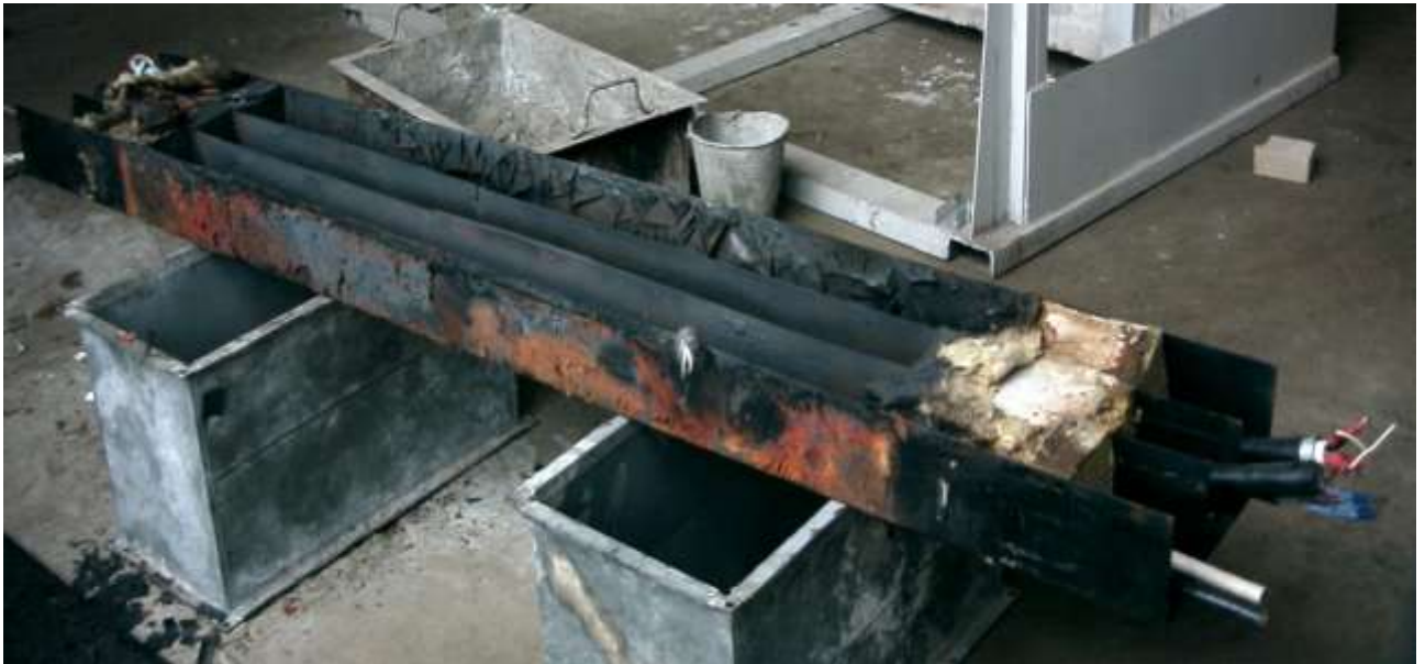
Рисунок 5 – Фотографія системи «короб – кабель» без огнезащитного покриття после испытания (крышка короба снята)
